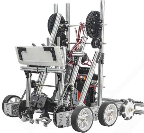
Le robot peut se déplacer sur le terrain, récupérer des pixels au sol, les faire monter à l'aide d'un bras élévateur, et les relâcher sur le plan incliné. Tout est montré dans [cette vidéo](#).
