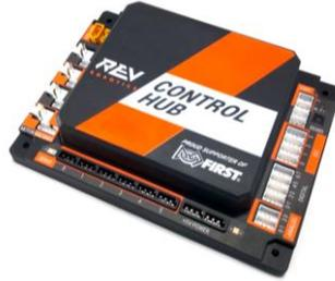
Le Microcontrôleur est le cerveau du robot, il permet d'établir des liens de communication entre les capteurs, les moteurs et la manette du pilote. C'est sur celle-ci qu'est téléversé le code du robot (programme en Java). En FTC, le Control Hub fait office de microcontrôleur. Voici le lien pour voir la documentation du Control Hub : <https://www.revrobotics.com/rev-31-1595/>
